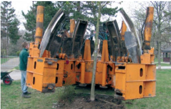
Mit einer speziellen Maschine – dem Baumspaten – werden die Bäume schonend aus dem Erdreich gebracht.
