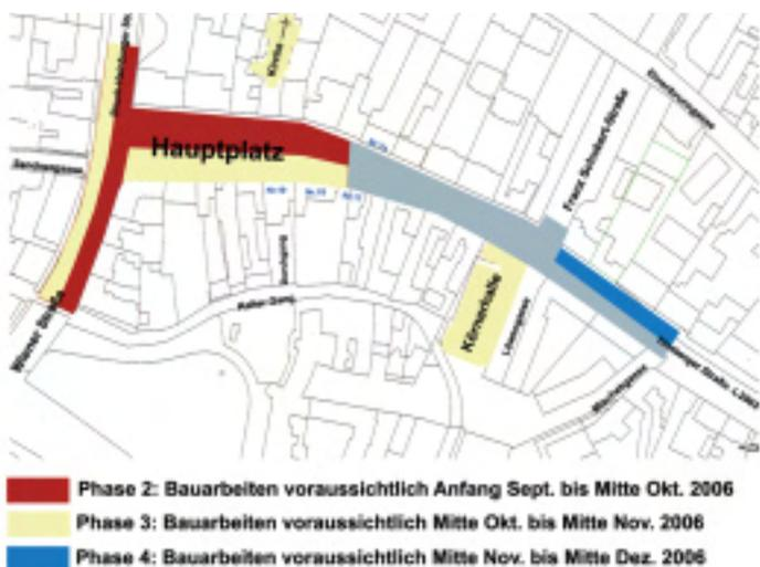
Der Hauptplatz wird in vier Bauabschnitten neu gestaltet. Abschnitt 1 (grau) ist bereits abgeschlossen, Abschnitt 2 (gelb) wird zur Zeit bearbeitet. Die Arbeiten dienen der Sanierung der Kanal- und Wasserleitungen und sollen noch in diesem Jahr abgeschlossen werden. Dann beginnt die Neugestaltung der Oberfläche.
